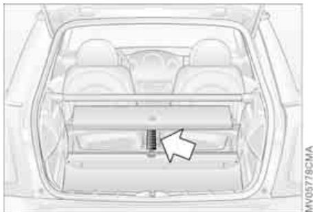
Das Warndreieck befindet sich unter der Laderaum-Bodenplatte.
