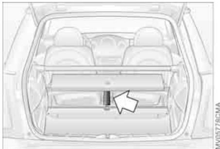
Il triangolo di sosta d'emergenza è collocato sotto il pianale del vano bagagli.
