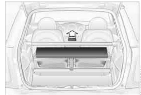
Unter der vorderen Laderaum-Bodenplatte befinden sich zwei zusätzliche Ablagefächer.
